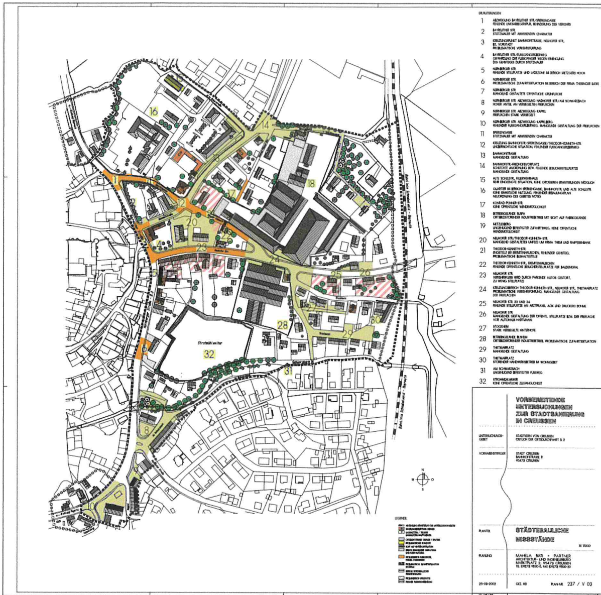
Abbildung 1: Vorbereitende Untersuchungen zur Stadtsanierung in Creußen Städtebauliche Missstände © architektur Ingenieurbüro Mahela Bär + Partner, Creussen 2003
